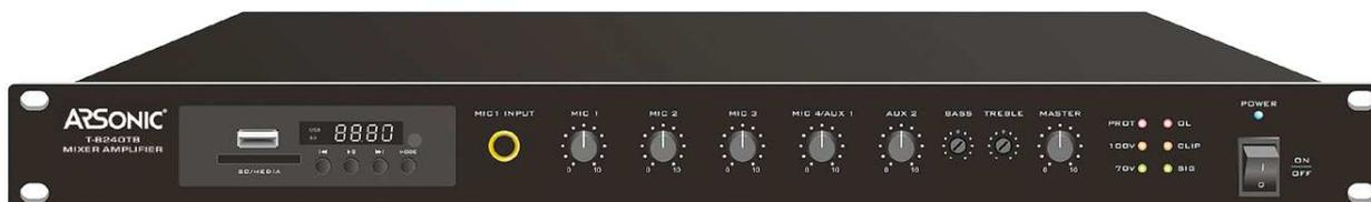
Der USB-Mischverstärker ist in den Leistungsklassen 60, 240 und 500 W verfügbar. Jeder Verstärker bietet vier Mikrofoneingänge, zwei AUX-Eingänge, einen Alarmsignal-Eingang und einen USB-Port sowie einen SD-Kartensteckplatz. Mit dem Alarmsignal-Eingang können alle Eingänge stummgeschaltet werden. Individuelle Lautstärkeregelung für Mikrofon 1-4 und AUX 1-2, Bass- und Höhenregelung sowie Einstellung der Gesamtlautstärke. Lautsprecheranschlüsse: 70 V, 100 V. Inklusive Fernbedienung.
